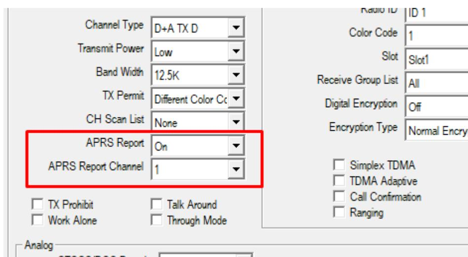
Hier gibt es zwei Optionen, die die APRS-Aussendungen steuern: APRS Report (kann auf On oder Off geschaltet werden und steuert hier generell, ob GPS-Daten geschickt werden sollen) und APRS Report Channel (wo wiederum der Kanal ausgewählt wird, der in den "Digital APRS Information" konfiguriert wird).
