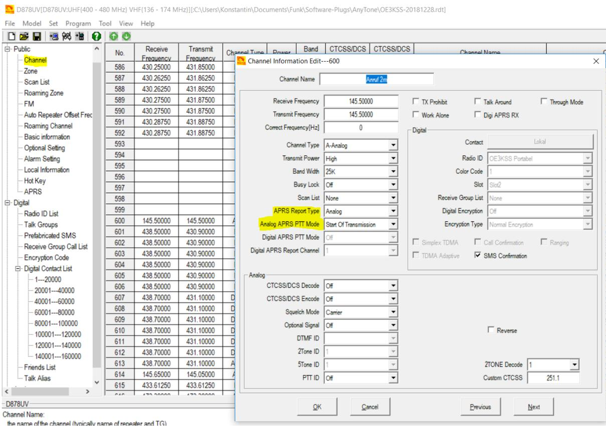
Wie beim digitalen Modus kann auch hier angegeben werden, ob zusätzlich zu den periodischen Baken auch vor oder nach einem eigenen Sendedurchgang eine Positionsmeldung ausgesendet werden soll. Sollten mehrere Kanäle (Haupt- und Subkanal) am Gerät aktiv sein, sendet das Gerät im Betriebsmodus des Hauptkanals die Baken aus.
